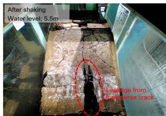
写真-1 横断亀裂からの漏水状況
