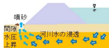
図1 パイピング破壊のイメージ図
