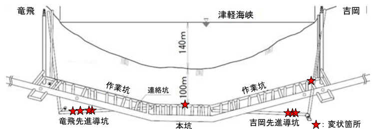
図1 青函トンネル作業坑・先進導坑の変状箇所
