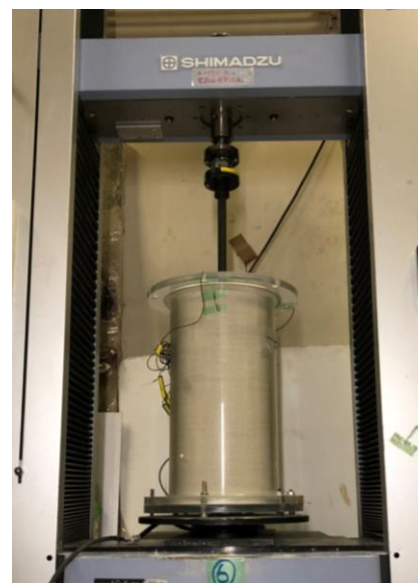
図-3 貫入試験状況
