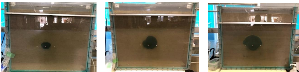
写真-2 養生 7 日後の土槽の様子 (左: 3%100ml/min 中央: 6%100ml/min 右: 6%200ml/min)
