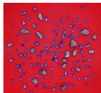
写真1 画像解析による盛土材の粒形認識例
