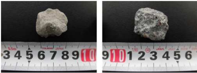
写真-2 製鋼スラグ骨材の洗浄前（左）と洗浄後（右）
