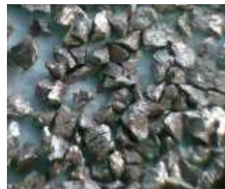
図-3 実験に使用したスチールグリッド 3) (株式会社ニッチュー)
