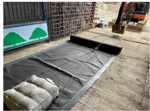
図-4 布製型枠／透気防水シートの摩擦係数試験状況
