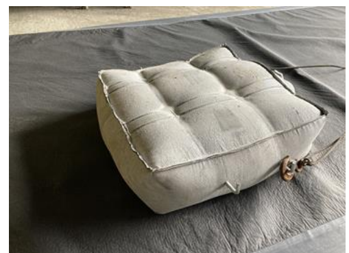
図-2 布製型枠試験体 (W650×L650×t250 mm, 重量約206.2 kg/個)
