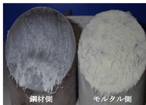
図-6 試験後のせん断面の一例 (テールグリース B, -20°C)
