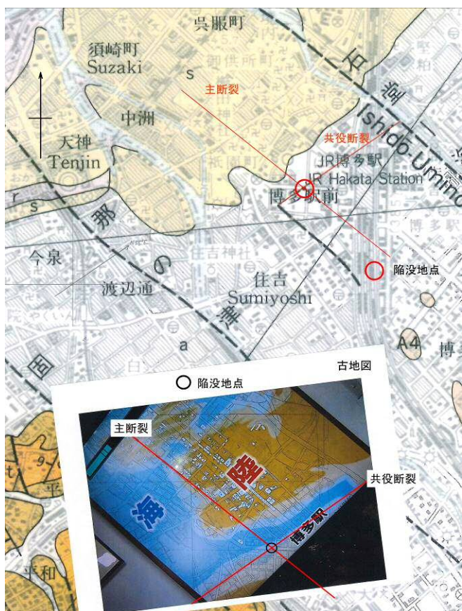
図-6 古地図と地質図から推定される断層交差点付近に位置する道路陥没地点
