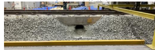
図-3 空洞構築状況
