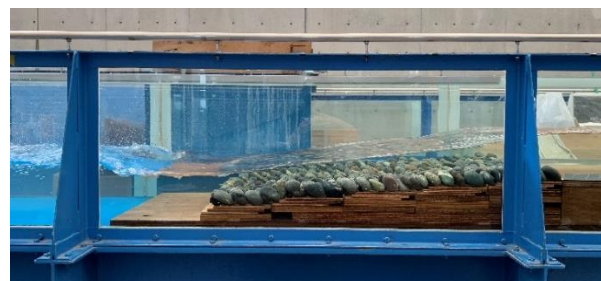
写真2 粗礫斜路周辺の洪水流の流況
