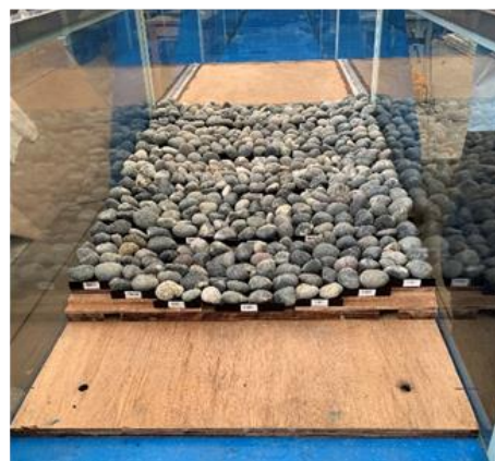
写真1 粗礫斜路の実験模型
