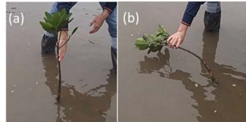
図1 マングローブ曲げ試験:(a)直立時(b)曲げ後
