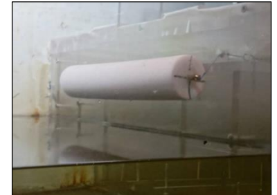
図-1 係留式越波対策工
