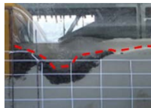
図7 Case5(腹付工5号砕石)の洗掘状況
