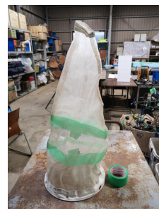
図2 観測②で用いる目詰まり設定用ネット(想定目詰まり率20%)
