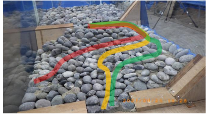
写真1 模型規模の石組み魚道（色線：遡上経路） 赤色：遡上経路1，黄色：遡上経路2，緑色：遡上経路3
