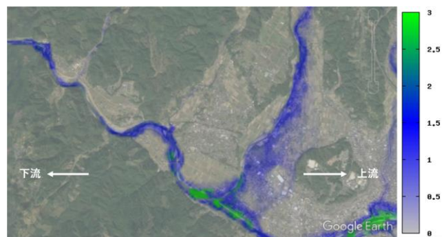
図-2 球磨川上流域(津波洪水が発生した地点)での氾濫解析結果(30mメッシュ, 7月4日16時半ごろ)
