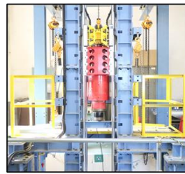
写真-1 重錘落下装置
