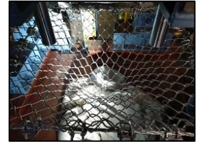
(a) 側方 (b) 上面 写真-4 重錘衝突後の供試体の状況
