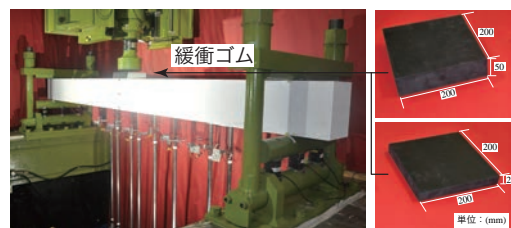
写真1 実験装置と試験体および緩衝ゴム設置状況
