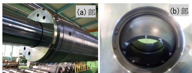
写真-2 耐久試験後の供試体 B の外観
