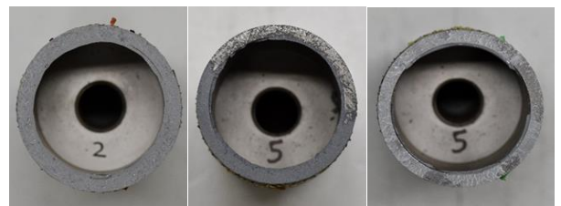
図-5 各荷重条件での破壊形式の一例
