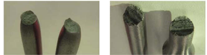
写真-1 引張試験体の破断面
