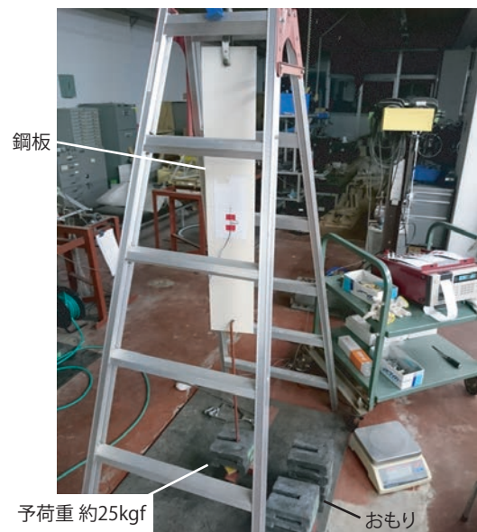
図-2 ひずみの計測装置
