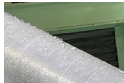
図 6 AGF-100FR を巻いたケーブル表面上の水路
