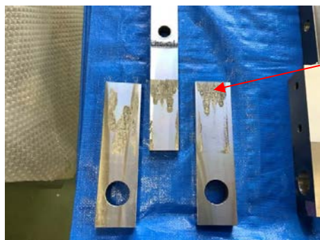
写真-3 試験終了後の状態（無塗装鋼材）
