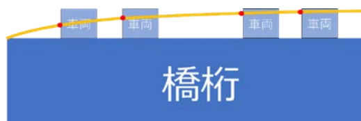
図4 橋桁端部から剥離したせん断流の概略図
