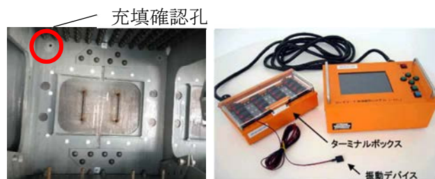
写真-1 充填確認孔と充填検知システム
