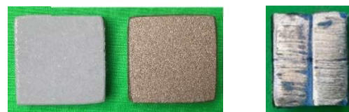
(a) 試験片の接合処理 (b) 接着後 (左：無機ジンク、右：ブラスト)
