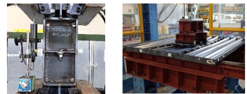
写真-2 引張試験状況 写真-3 添接曲げ試験(負曲げ)
