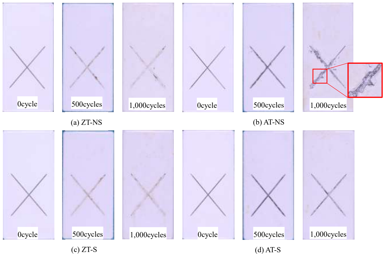
図-3 1,000cycles 後の試験体の表面状態
