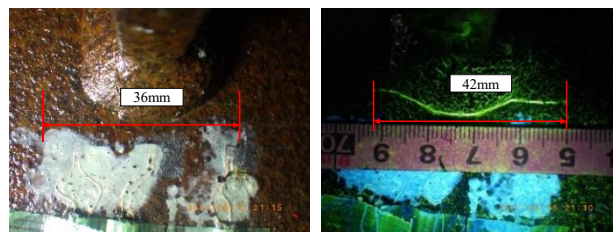
(a) 目視 (最大荷重時) (b) 磁粉探傷試験 (最大荷重時)
