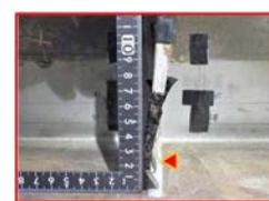
(b) No. ②の座屈部詳細 写真-1 試験後の座屈形状
