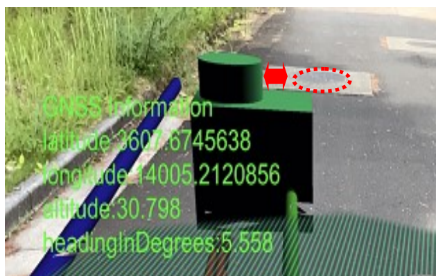
図-5：3D モデルと現実空間のズレ
