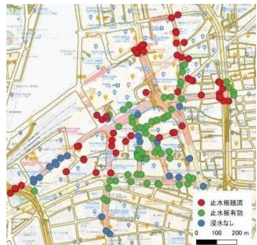
図-5 止水板が有効/越流する出入口 (Google Map 加筆)
