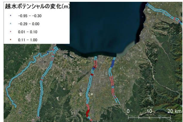
図-3 伐採による越水ポテンシャルの変化
