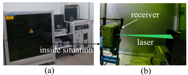
図 1 LUVT 装置 (a) 装置全体図 (b) 実際の LUVT の様子.
