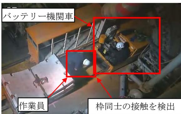
図 3 バッテリー機関車と作業員の接触
