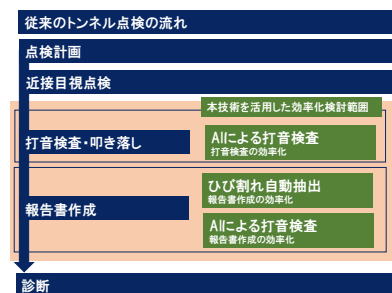
図-1 接近点検代替手法の考え方
