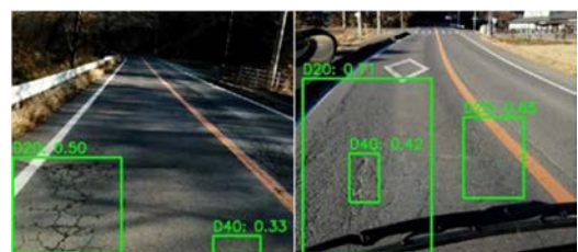
図-2 AIによる路面診断の例
