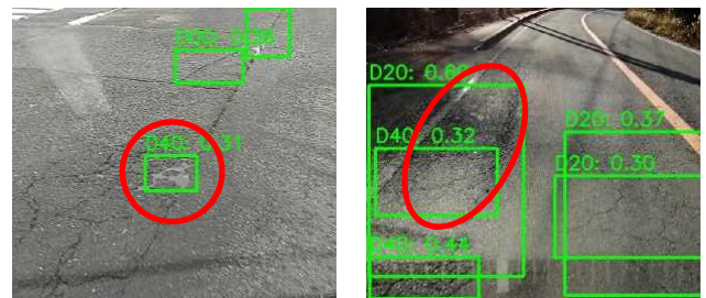
図-5 ポットホールと検出された損傷
