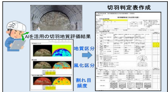
図-7 AI による切羽地質評価支援システム運用イメージ
