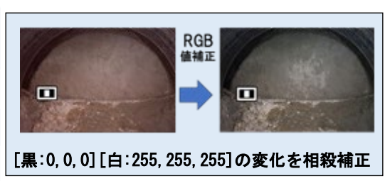
図-4 色見本を用いた補正の例
