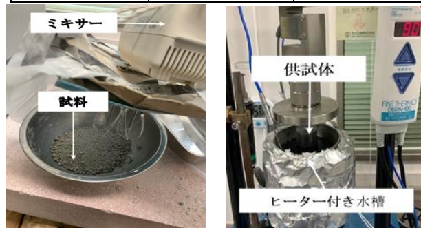
① 飽和度調整の様子 ② 一軸圧縮試験の様子
