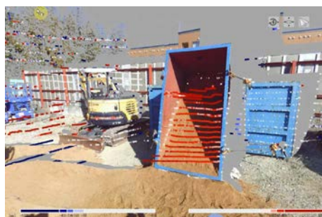
図-5 点群データと差分値のリアルタイム表示(左:VLP-16, 右:OS1-128)
