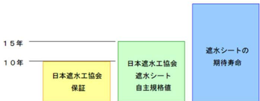
図3 日本遮水工協会における自主規格値と日本遮水工協会の保証 4)
