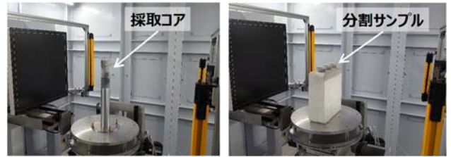
図 2 採取コアと分割サンプルの撮影状況
