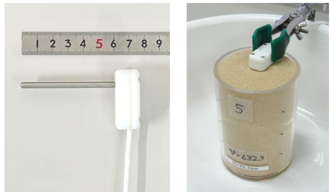
図-1 (左)熱伝導率センサー (RK-3), (右)乾燥砂への設置状況 (内径 0.96~9.5 cm の容器を使用)
