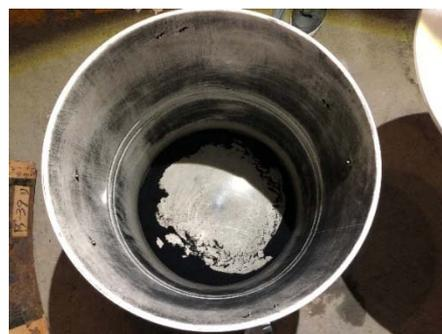
写真-4 集塵サイクロンによる捕集状況 (コールド試験)
