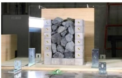
図1 作成した石橋断面モデル
