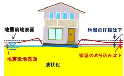
図-2 被災のメカニズム 2)
